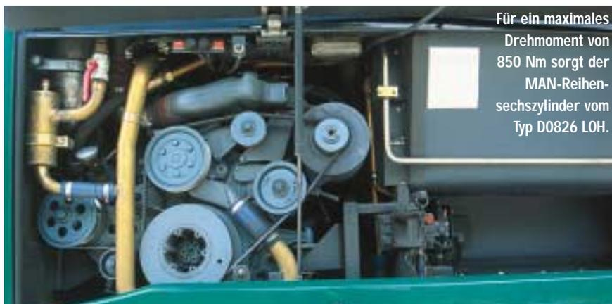
Für ein maximales Drehmoment von 850 Nm sorgt der MAN-Reihensechszylinder vom Typ D0826 LOH.
