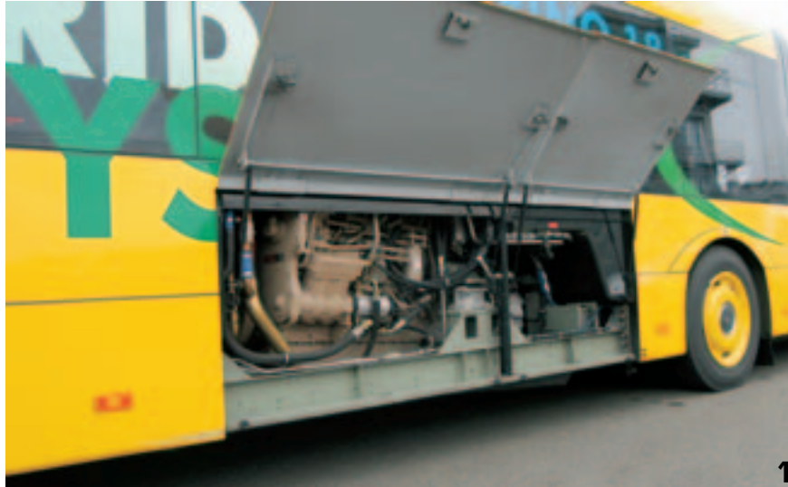
Foto 1: Links stehend zwischen den Achsen der Antriebsatz, leicht geneigt montiert für einen besseren Anschluss an die Portalachse.
