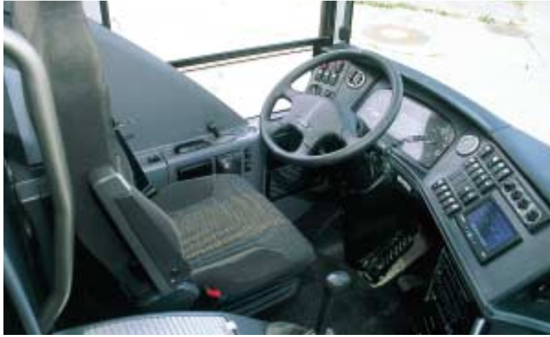
Im Kontrast zur Avantgarde: Das übersichtliche und ergonomisch tadelnsfreie, aber nur wenig appetitliche Armaturenbrett des Vacanza mit Zentral- und Navigations-Display.
