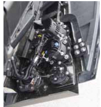
... die Leuchtmittel der Scheinwerfer sind gut austauschbar.
