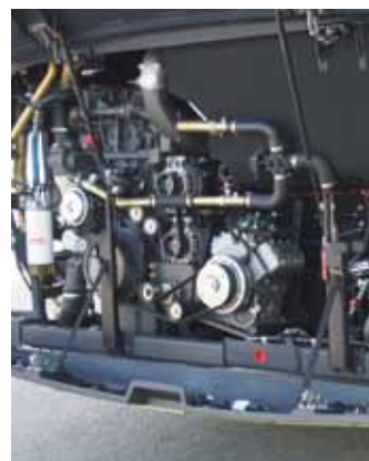
Links stehend im Heck: MX11-Sechszylinder von DAF, bis zu 370 PS sind möglich.
