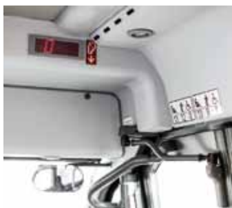
Die bessere Lösung: Die Türführung oben gewährt unbedingte Betriebssicherheit.
