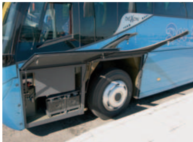
Saubere Lösung hinter Klappen – die Batterien sitzen im Gefahrenbereich.
