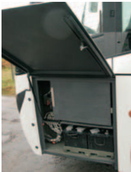
Radwechsel einfach gemacht, wenn das Radlauf klappbar ist. Die Batterien in unfallträchtiger Lage. Hohes Kofferraumvolumen von 6 m 3 , auf der linken Seite das Reserverad.
