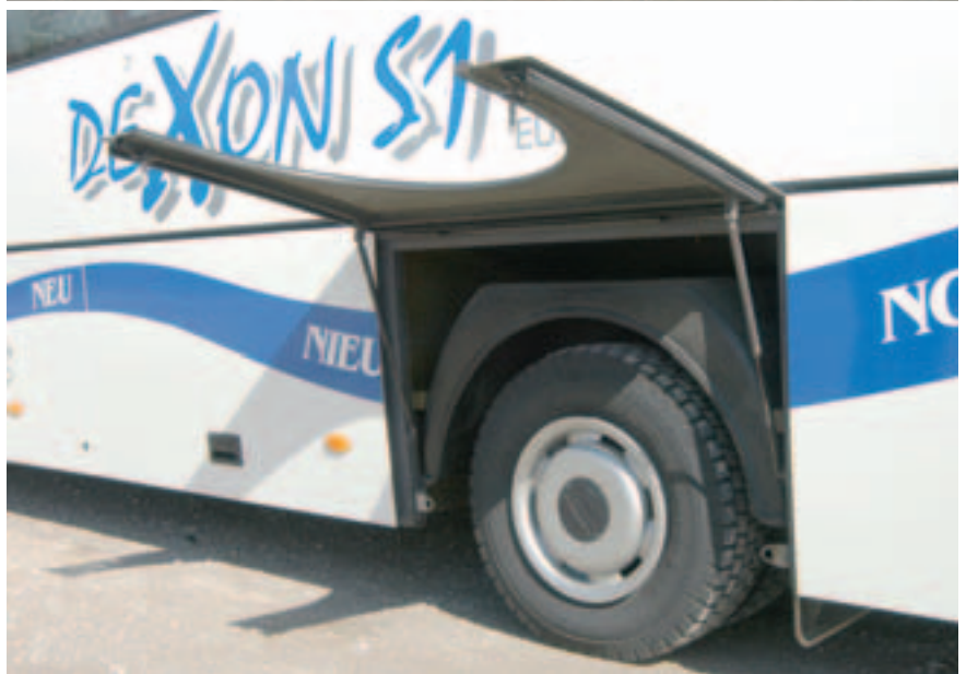
In Sachen Kofferraum ein Großer – 6,9 m 3 kann manch großer Bus nicht. Saubere Lösung an der Hinterachse – klappbare Radläufe mit Innenkotflügel
