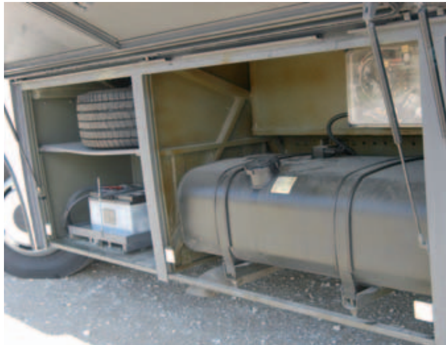
Links hinter dem Fahrer hat die Feststellbremse nichts zu suchen. Stilleben unter der linken Klappe – das Reserverad wäre rechts besser aufgehoben.
