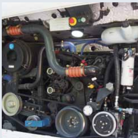
Gut gefülltes Midi-Heck: Cummins-Sechszylinder mit 250 PS, motorfester Klimakompressor, Lüfterantrieb mit Kardanwelle und Viscokupplung.
