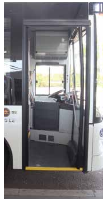
Schmalere Einstieg vorn, bedingt durch den knappen vorderen Überhang.
