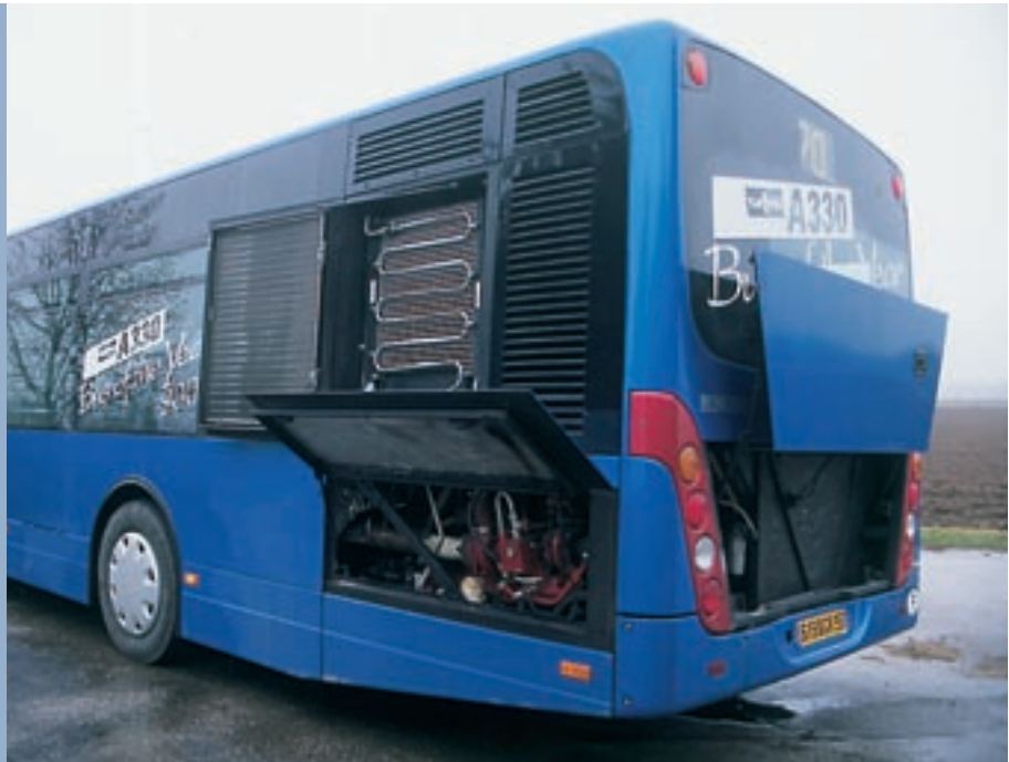
Links stehend im Heck der kleinvolumige MAN-Reihensechszylinder mit 280 PS Nennleistung und 1.100 Nm Drehmomentmaximum – darüber angeordnet die Motorkühlung.
