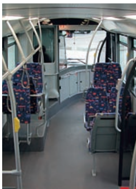
(von oben nach unten) Drei Türen mit sehr niedriger Einstiegskante, gut für raschen Fahrgastfluss – an der Mitteltür eine elektrisch ausfahrbare Rollstuhlrampe. Breiter Durchgang von Tür 1 zur Fahrzeugmitte – Stehfläche mit Klappsitzen, komfortable Bestuhlung aus hauseigener Herstellung. Glatter reinigungsfreundlicher Innenboden – als Zugeständnis an den besonders niedrigen Einstieg befinden sich die meisten Sitze auf Podesten.
