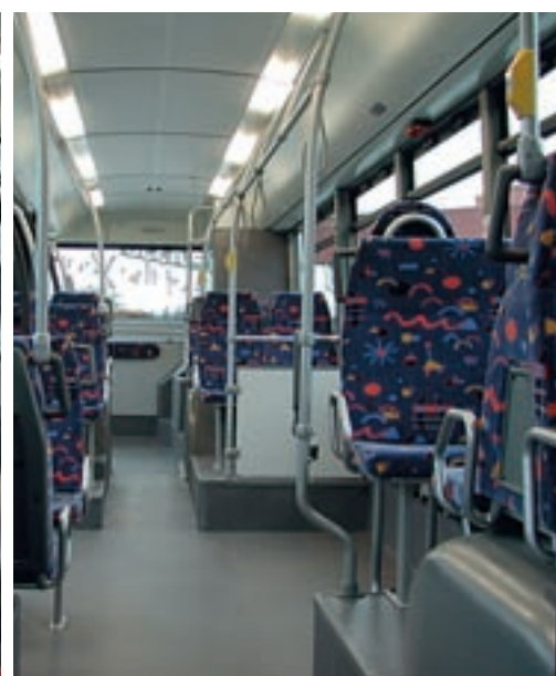
(von oben nach unten) Drei Türen mit sehr niedriger Einstiegskante, gut für raschen Fahrgastfluss – an der Mitteltür eine elektrisch ausfahrbare Rollstuhlrampe. Breiter Durchgang von Tür 1 zur Fahrzeugmitte – Stehfläche mit Klappsitzen, komfortable Bestuhlung aus hauseigener Herstellung. Glatter reinigungsfreundlicher Innenboden – als Zugeständnis an den besonders niedrigen Einstieg befinden sich die meisten Sitze auf Podesten.
