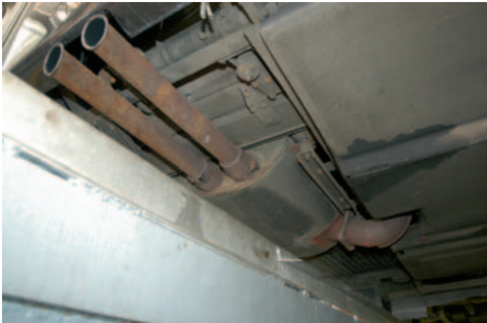
Beim nächsten Service fällig – der Endschalldämpfer samt Endrohren.
