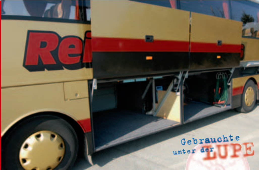
Gut schließender Kofferraum – die Schlösser mit eigenen Schmiernippeln halten ewig.
