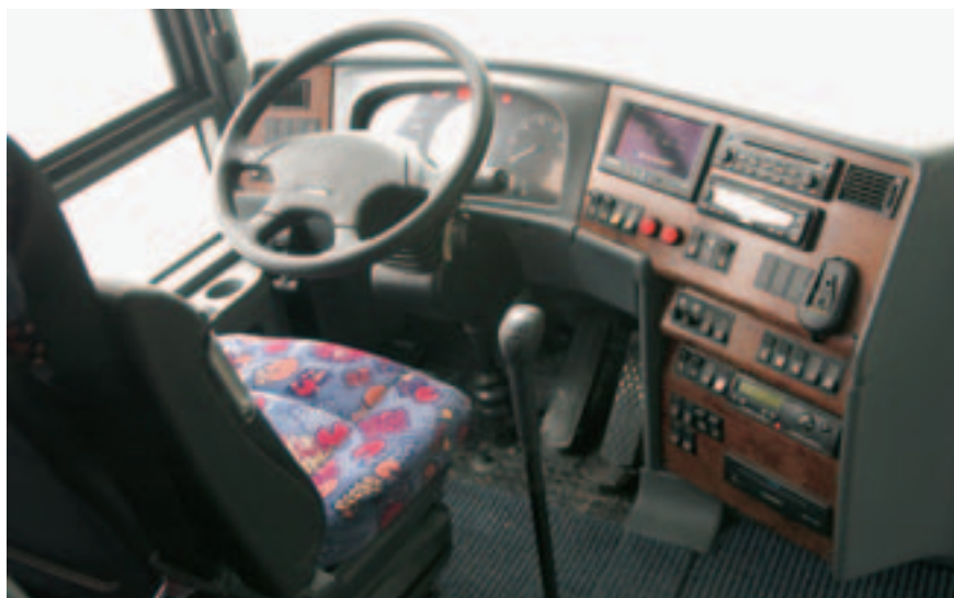
Fahrerarbeitsplatz mit geringem Platzangebot, pneumatisch verstellbares Lenkrad, bequemer Fahrersitz
