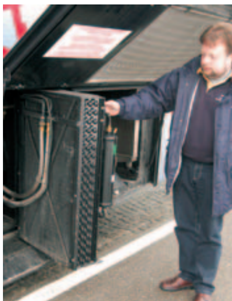
Mit 6 m 3 ausreichend Kofferraum, satt schließende Klappen, geschützte Zentralelektrik (Foto o.); der Klima-Wärmetauscher – reinigungsfreundlich aufklappbar (Foto u. l.); nicht jeder kann es – offene Tür bei voll eingeschlagenen Vorderrädern (Foto u. r.)
