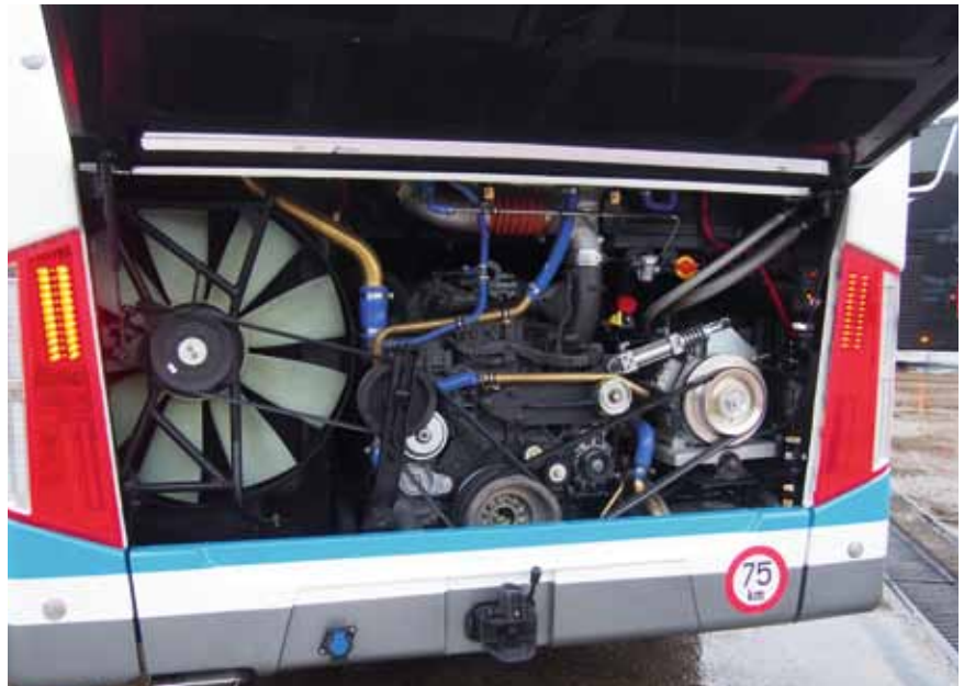
Triebwerk im Heck: DAF MX13-Sechszylinder, 510 PS, 2.500 Nm max. Drehmoment
