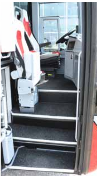
Solide Lösung: Türblattführung innen an der Vordertür
