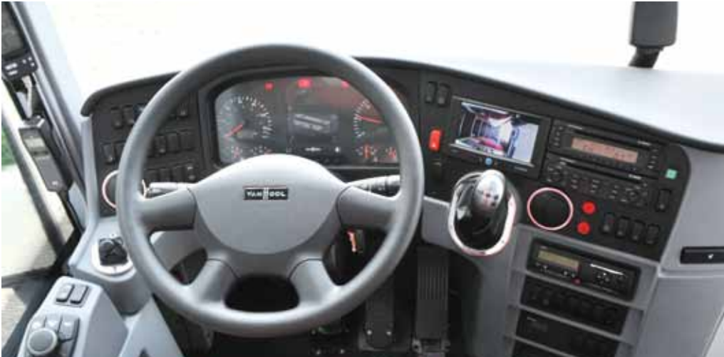
Neuordnung für die Schalter, Joystick am Armaturenräger. Rechts: Eigenheit – zwei Außenspiegel links
