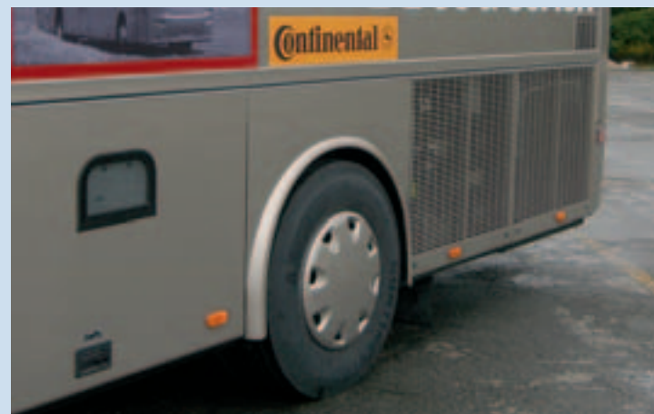
Conti HSL1: breite Aufstandsfläche für gute Bremsleistungen
