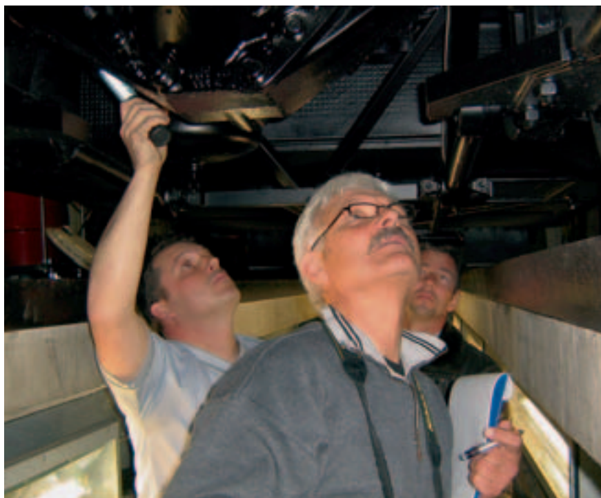
Wartungsaufwand beim Bova – Schmiernippel am Fahrwerk
