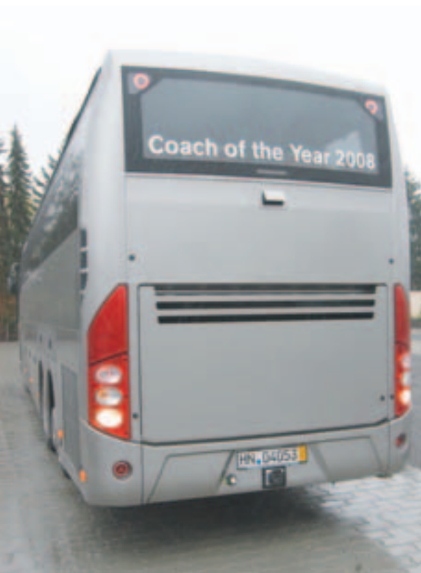
Große Leuchteinheiten im Heck, optional mit aufklappbarer Rückfahrkamera. Ansteigende Sitzreihen bieten allen freie Blicke nach vorn – aber knappe Kopffreiheit hinten.
