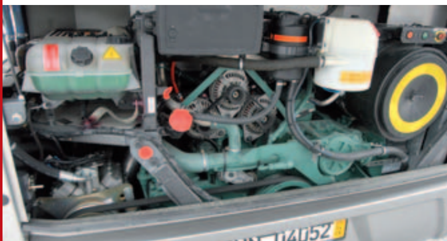
Platzsparend liegend im Heck: 12,1-l-Sechszylinder in zwei Leistungsklassen
