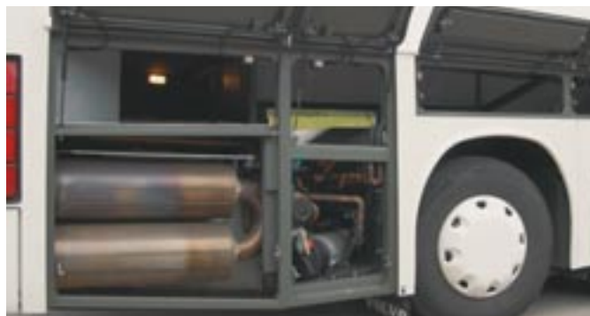
Viel zusätzlicher Platz durch den liegenden Motor, die Auspuffanlage wird korrosionsfest in V2A-Stahl gefertigt.
