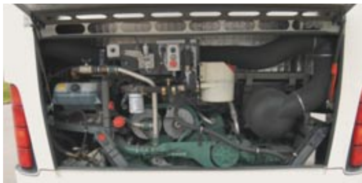
Volvo-typisch liegender Sechszylinder mit 380 PS und 1.850 Nm Drehmoment, wenig Lärm und Wärmeentwicklung im Innenraum.
