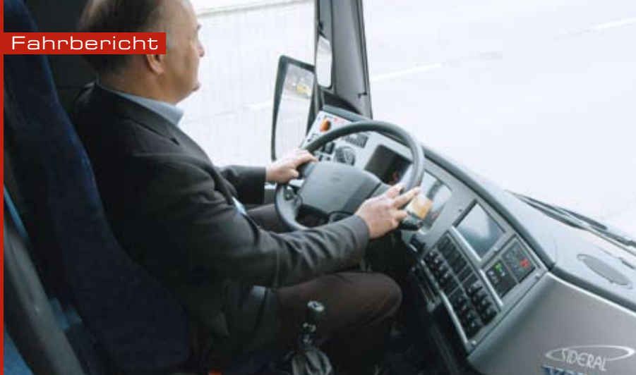
Fahrerorientiertes Cockpit mit Appeal, kurze Sitzschienen, komfortabler Isri-Sitz
