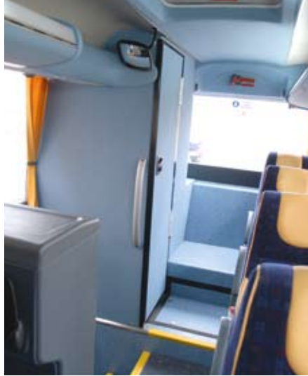
Hecktoilette und Kompaktküche im hinteren Aufgang
