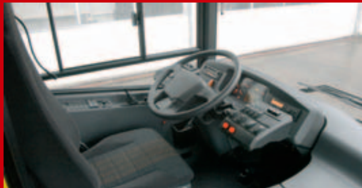
Dominant im Cockpit das große Lenkrad, zu beiden Seiten die Satelliten mit gut sortierten Schaltern.
