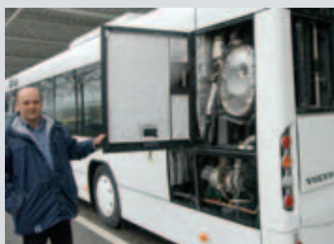
Über dem Motor die Abgasanlage samt SCR-Kat, auf dem Dach darüber die Kühlereinheit.
