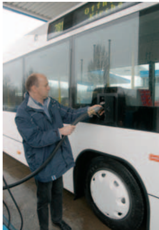
Tanksystem mit zwei Klappen – Diesel wird vorn getankt, der 50-Liter-Vorratsbehälter für Adblue sitzt hinten.
