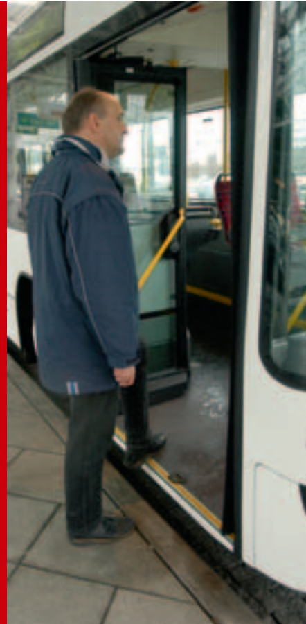
Mit Kneeling-Funktion geht es besser – ebener Zugang an der Haltestelle.
