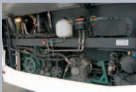
Links stehend der kompakte Sechszylinder mit 310 PS, rechts daneben der kompliziert angetriebene Klimakompressor.
