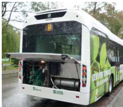
Der Vierzylinder-Diesel steht leicht geneigt links im Heck.
