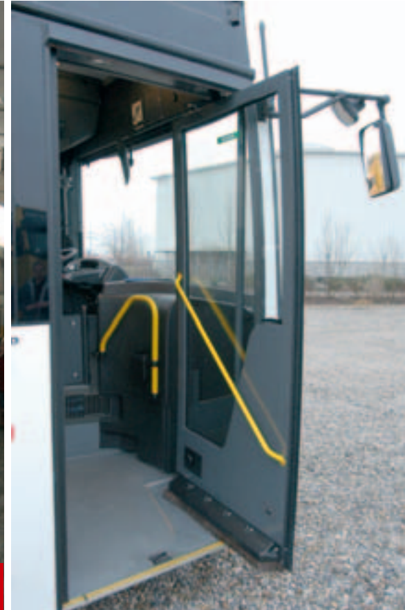
8700 mit Kanten und Ecken - von Bus bis Heck ein klassischer Volvo Schwedische Lösung – die breite Innenschwenktür steht geöffnet nicht bündig.
