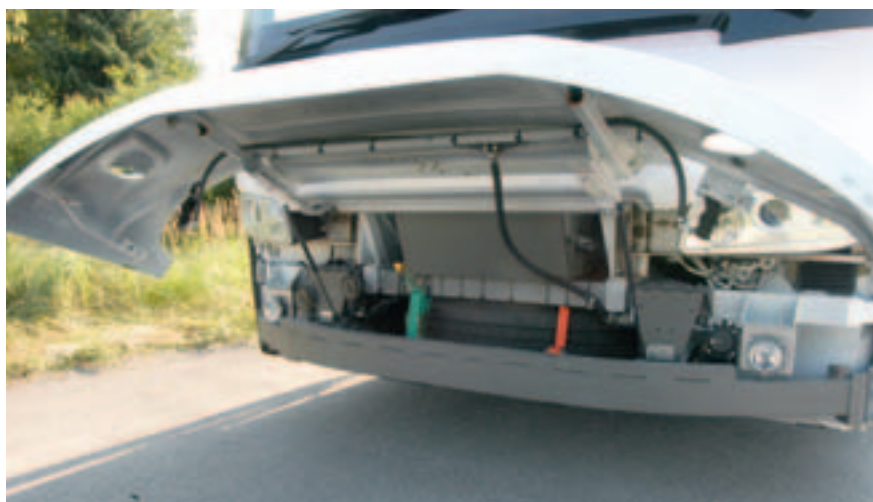
Massiver Unterfahrschutz im Bug – PKW werden bei Unfällen nicht überrollt.
