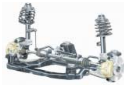
Vorderachse mit McPherson-Federbeinen. Ein vom Aufbau entkoppelter Hilfsrahmen eliminiert Abroll- und Antriebsgeräusche.
