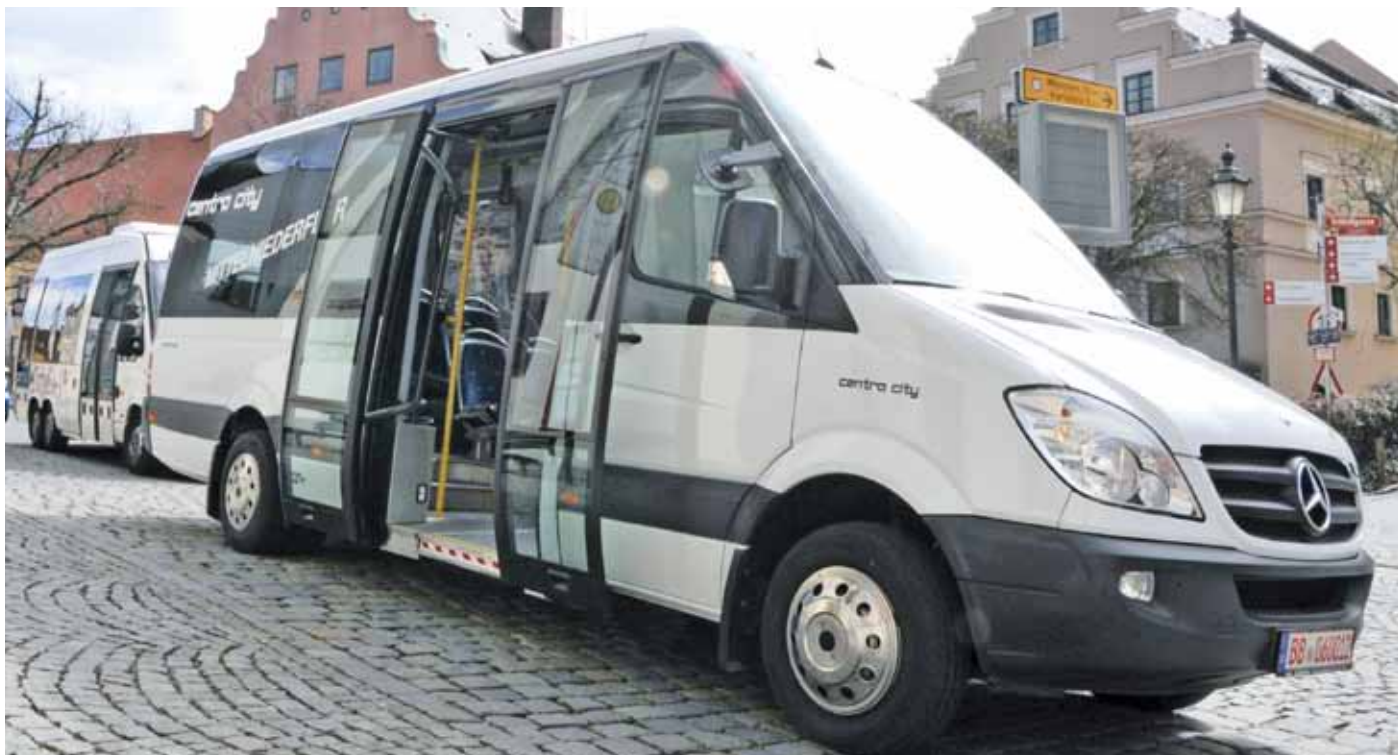
Die breite Außenschwingtür von Bode wird im Centro City weiter hinten montiert.
