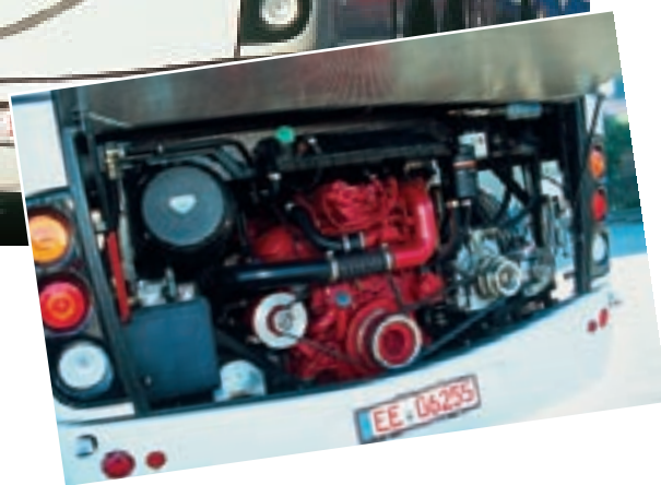
(oben) Beschwingte Optik auch am Heck: Über der Motorklappe sitzen die Lüftungsgitter der Klimaanlage. (rechts) Kraftwerk von MAN: der 460 PS starke Sechszylinder
