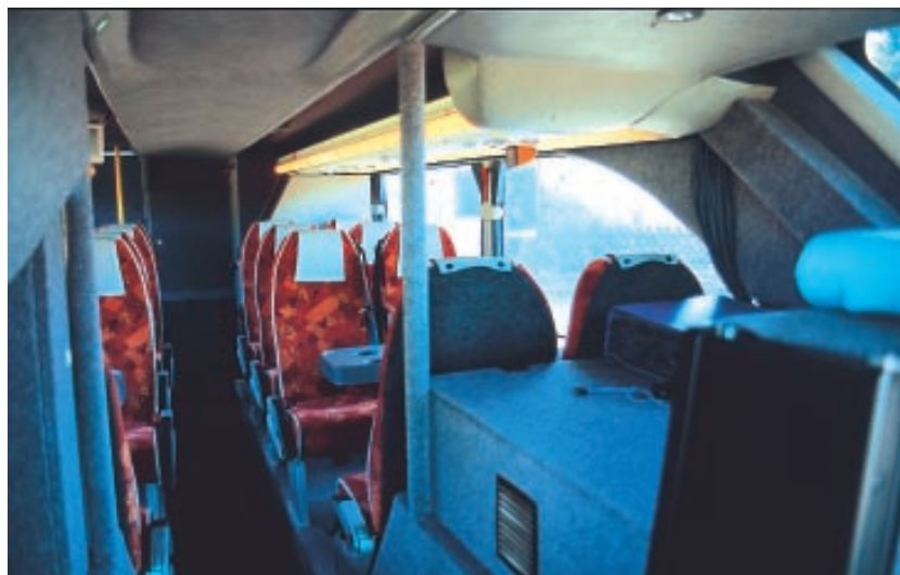
54 Sitzplätze in der ersten Etage, der Boden hat Stufen nach vorne und ins Heck, die Stehhöhe beträgt maximal 1.720 mm. Clubbus-Atmosphäre mit nur 18 Sitzplätzen, Bordküche und Toilette im Untergeschoß.
