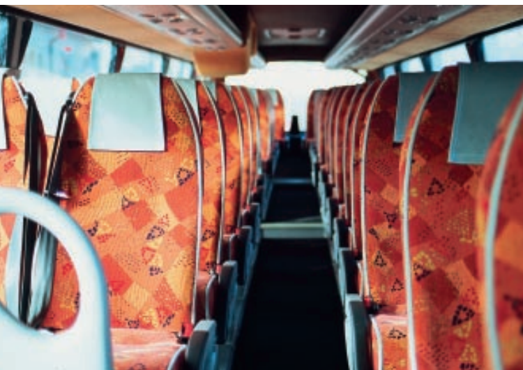
54 Sitzplätze in der ersten Etage, der Boden hat Stufen nach vorne und ins Heck, die Stehhöhe beträgt maximal 1.720 mm. Clubbus-Atmosphäre mit nur 18 Sitzplätzen, Bordküche und Toilette im Untergeschoß.
