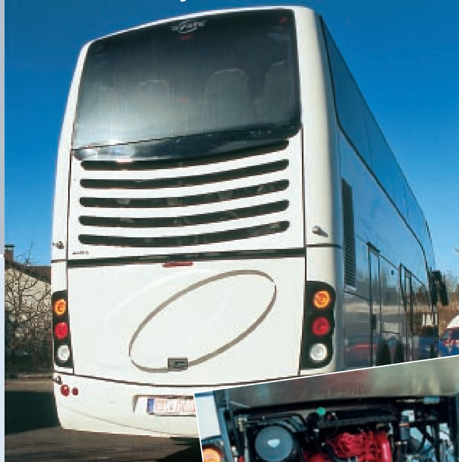
(oben) Beschwingte Optik auch am Heck: Über der Motorklappe sitzen die Lüftungsgitter der Klimaanlage. (rechts) Kraftwerk von MAN: der 460 PS starke Sechszylinder
