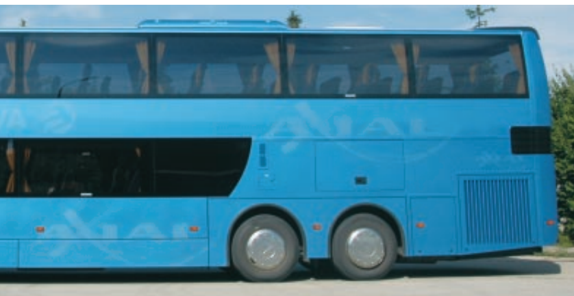
Auf 13,9 m Länge eigenwillige Proportionen – kurzer vorderer Überhang und Aufdachklimaanlage.
