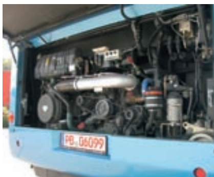
Stehender Reihensechszylinder mit 12,6 Litern Hubraum, 430 PS Nennleistung, Klimakompressor separat rechts unten montiert
