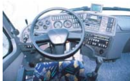
Etwas in die Jahre gekommen: der Bova-Armaturenräger mit vielen Analoginstrumenten und dem Retarderhebel links, gegen Aufpreis das VDO-Dayton-Navigationssystem.
