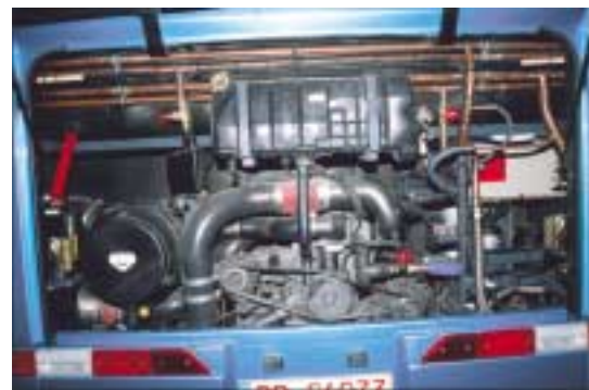
Weniger ist mehr: Im Heck des Futura sorgt der 380 PS starke DAF-Sechszylinder für standesgemäße Fahrleistungen.
