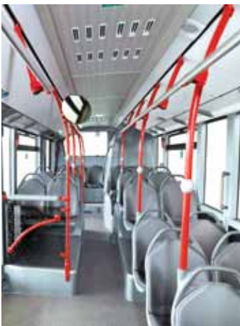
Schneller Zugang zur Rollstuhl- oder Kinderwagen-Abstellfläche rechts neben Tür 2
