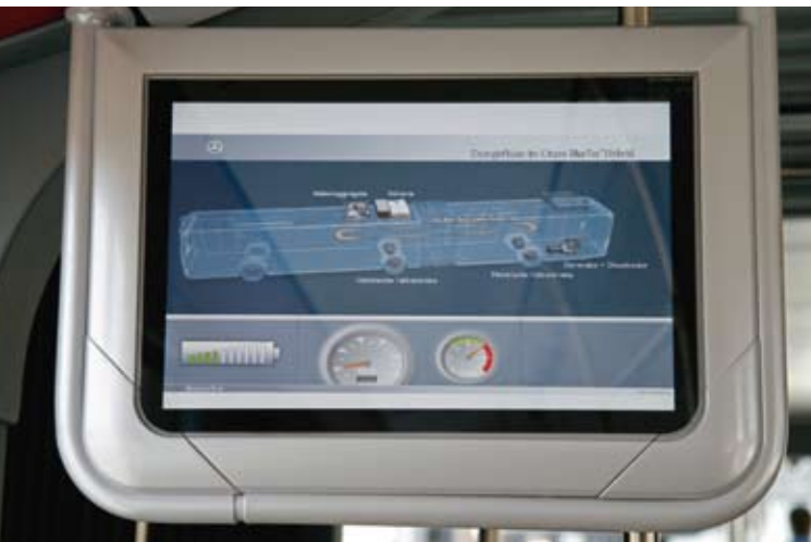
Laut Display-Anzeige lädt der Diesel unter Volllast, die Batterie hat nur halbe Kapazität.
