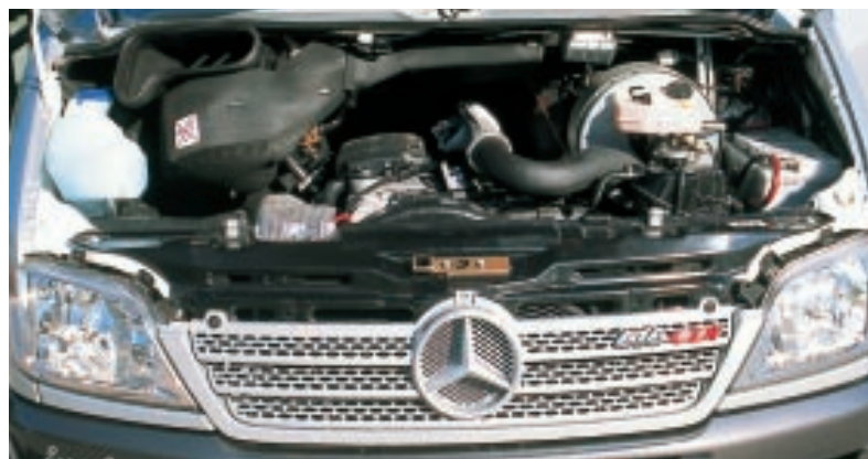
(links) Ausgestellte Radhäuser an der Hinterachse verweisen auf die breitere Hinterachse aus dem Vario-Programm. (rechts) Starkes Herz unter der Fronthaube: Fünfzylinder-Turbodiesel mit Common-Rail-Einspritzung, 2,7 l Hubraum und 156 PS
