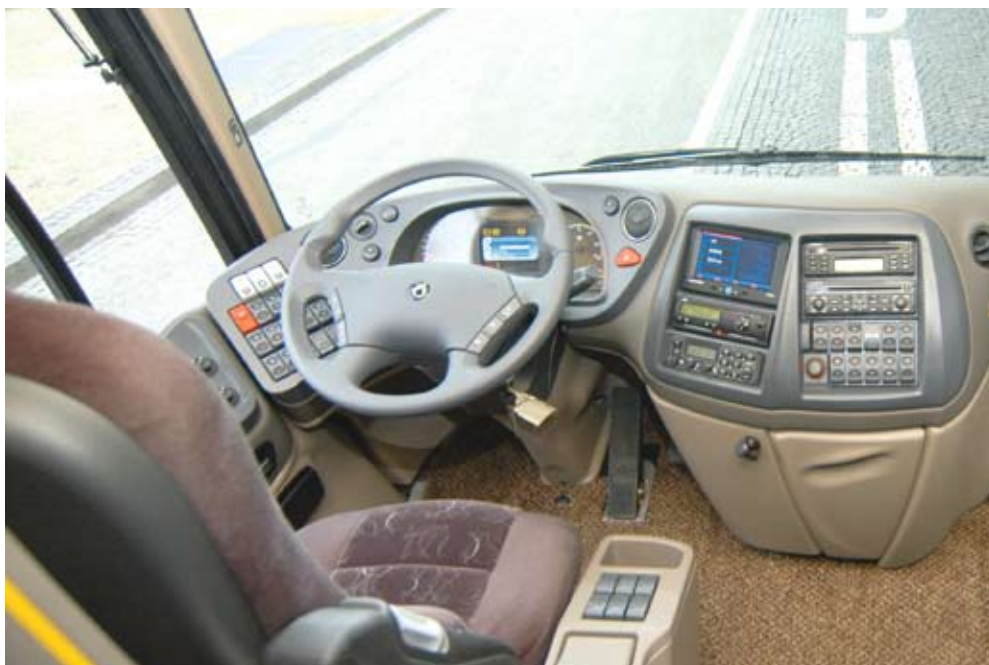
Magelys-Kommandostand aus einem Guss: mit großem Multifunktionslenkrad, AS-Tronic, nicht immer handgerecht die Bedienelemente und Schalter
