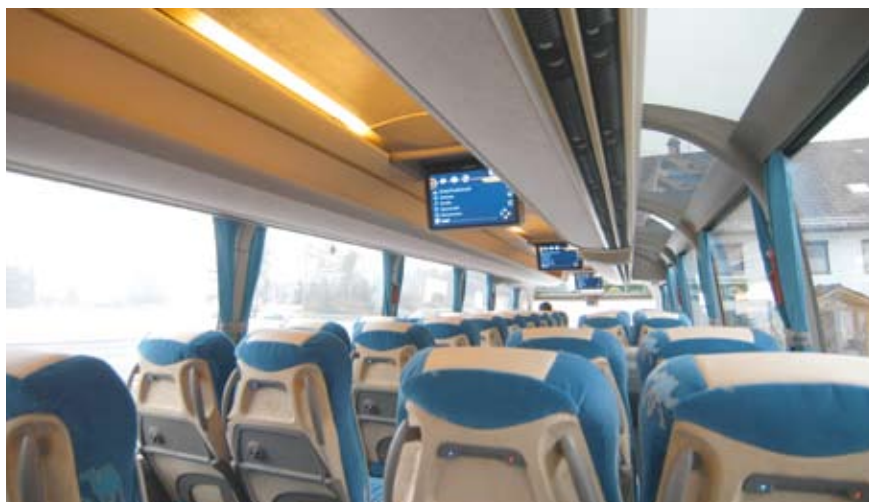
Panorama-Blick aus der Dachrandverglasung – in Dachmitte die Infotainmentanlage mit drei 19-Zoll-Bildschirmen
