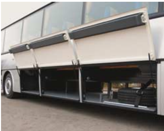
Mehr als 6 m 3 Kofferraum unter den Klappen, das Reserverad bleibt besser in der Werkstatt.
