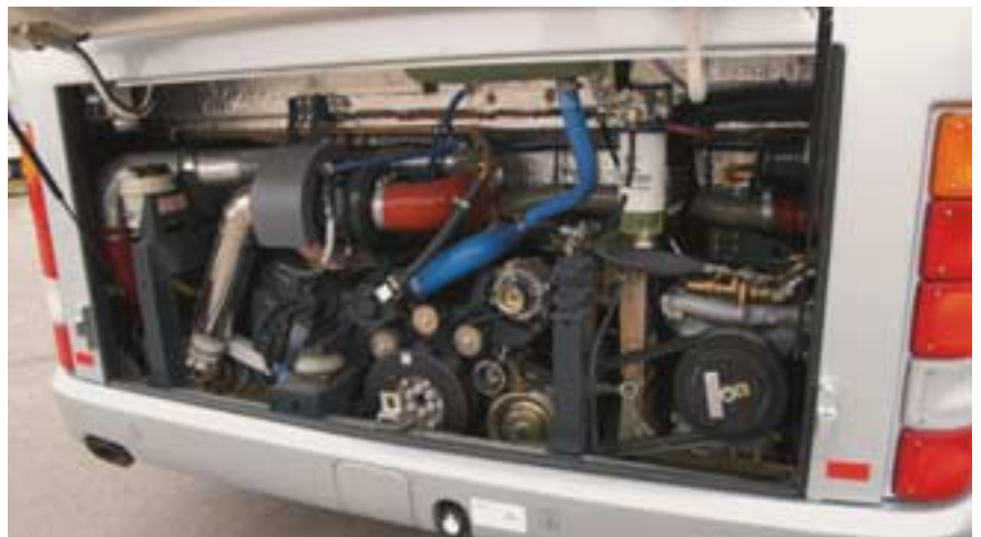
Im Heck ein modernes Triebwerk – liegender Cursor 8-Sechszylinder mit 352 PS und hydrostatischem Lüfter, separat gelagert der Klimakompressor.
