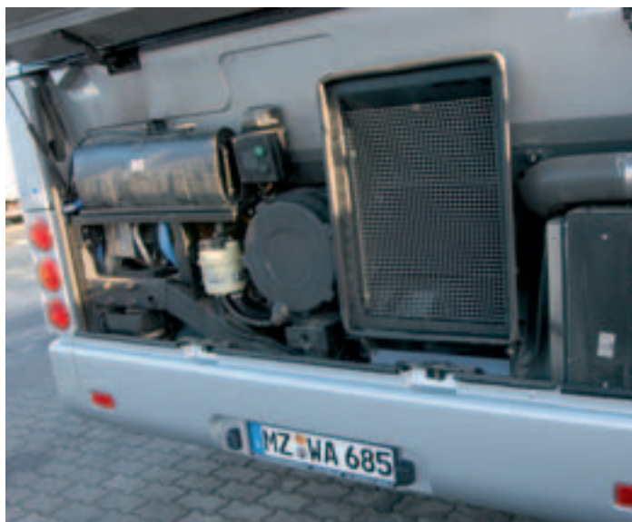
Kraftvoller Sechszylinder links im Heck, außen laut, innen leise.
