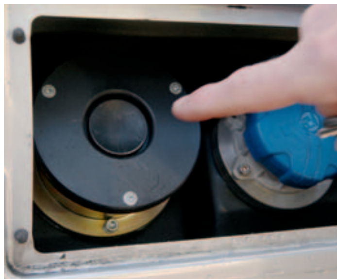
Unter einer Klappe: 250 Liter Diesel und 60 Liter Adblue.
