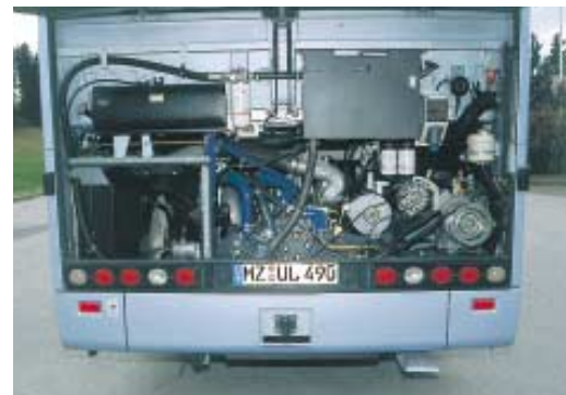
Kraftquelle im Heck: Laufruhiger Common-Rail-Reihensechszylinder mit 431 PS und 1.870 Nm maximalem Drehmoment.
