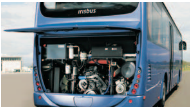
Vorbildlicher KTL-Korrosionsschutz im tschechischen Karosa-Werk; Kleinvolumige Iveco-Motoren mit moderner Technik, links der Hydrolüfter
