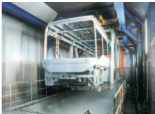
Vorbildlicher KTL-Korrosionsschutz im tschechischen Karosa-Werk; Kleinvolumige Iveco-Motoren mit moderner Technik, links der Hydrolüfter
