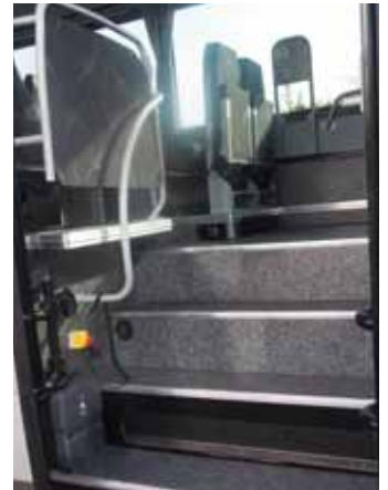
Breites Portal in Fahrzeugmitte: In Stufe 1 hinter den asymmetrischen Türflügeln kann ein hydraulischer Hublift montiert werden.
