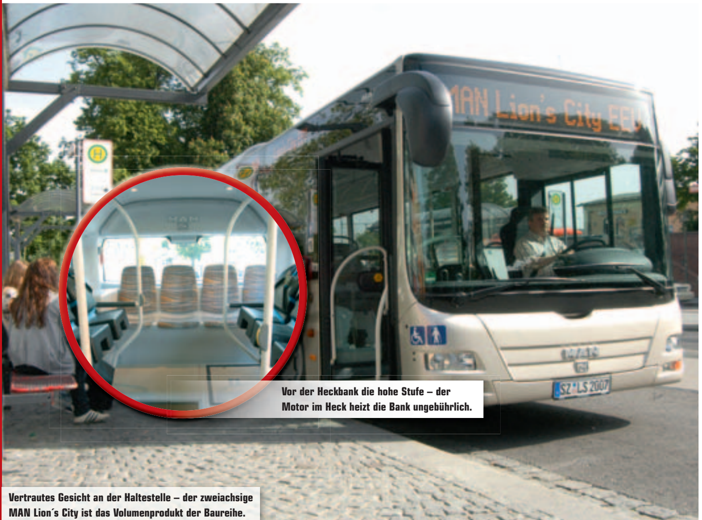
320 mm Einstieghöhe – fast auf Randsteinniveau
