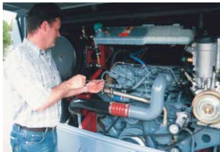
Das Powertriebwerk mit 460 PS: hoher Antriebskomfort, servicefreundliche Anordnung der Motorperipherie und der Aggregate
