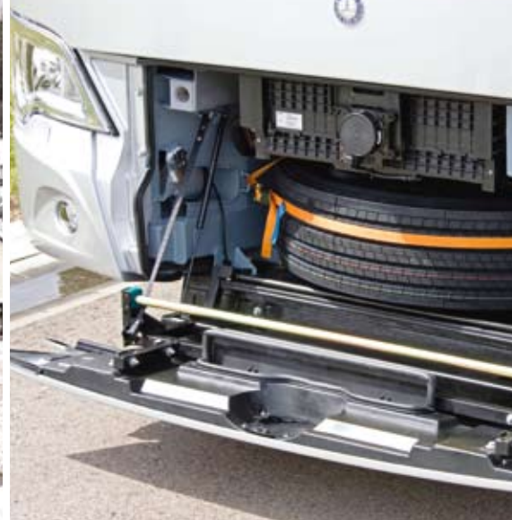
Unter der Bugschürze das Radarauge für ART und ABA – dahinter die Struktur des Front Collision Guard
