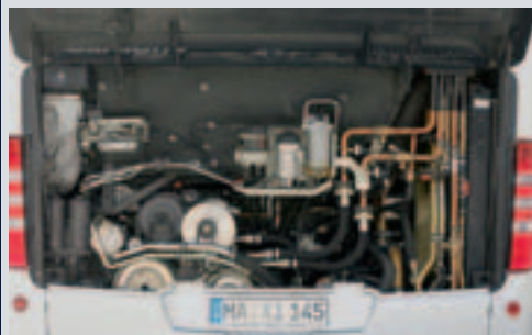
Bewährt stämmig, aber laut – links liegend der OM457 hLA mit 354 PS und 1.600 Nm Drehmoment.
