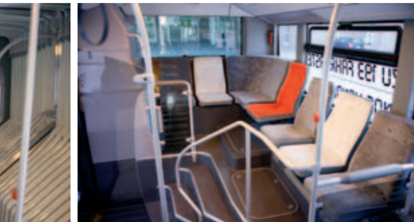
Nicht optimal im Heck – das Achsrohr der Nachlaufachse bedingt den stufigen Aufbau hinten.
