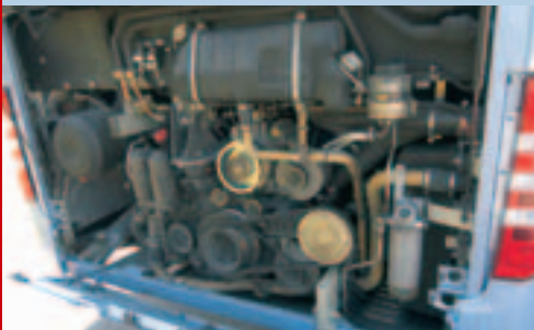
Liegender Reihensechszylinder OM 457 hLA, hydrostatischer Lüfter rechts, motorfester Klimakompressor.
