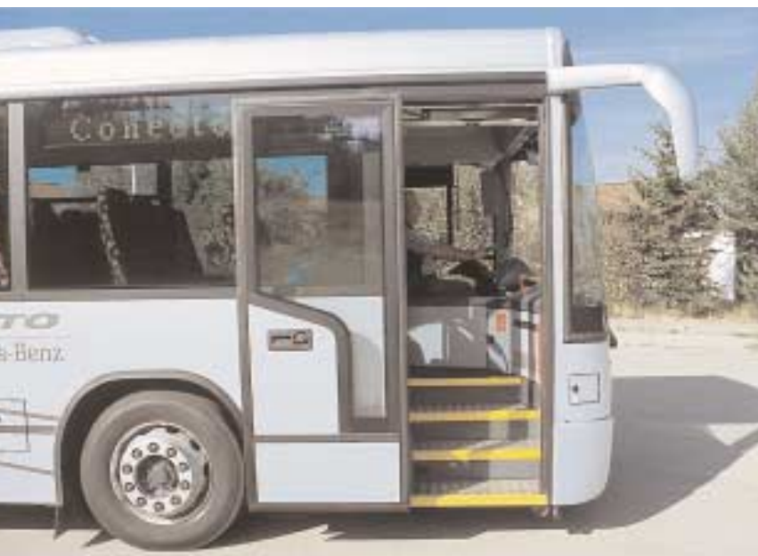
Einstiegshöhe 350 mm, über drei Stufen gelangt der Fahrgast in den Innenraum.
