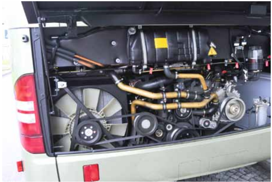
Downsizing im Heck: Der Sechszylinder OM 926 LA hat nur 7,2 l Hubraum.
