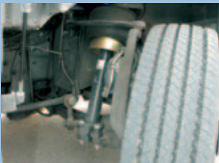
Diese Vorderachse ist eine Zierde – Doppelquerlenkerachse mit Federbeinen von ZF Sachs.
