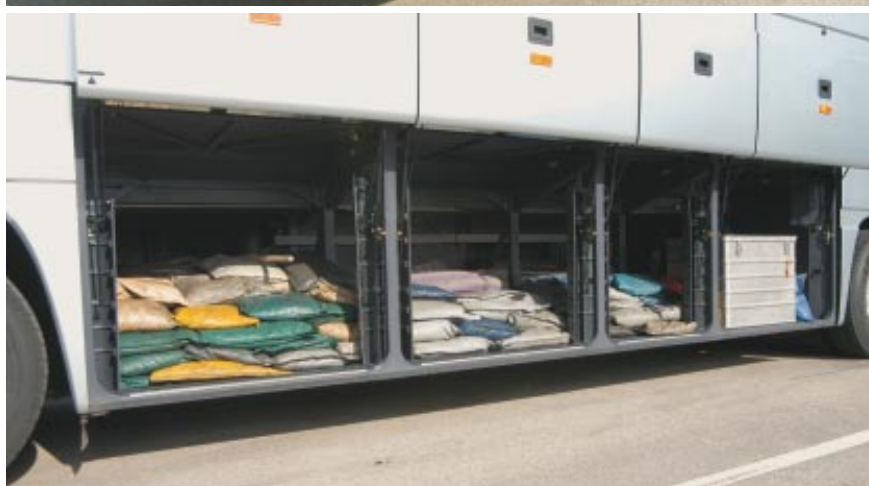
Riesiger Kofferraum mit 11,6 m 3 Fassungsvermögen, wahlweise Klappscharniere oder Parallelhubklappen. Von Sicherheitsexperten beanstandet – die Elektrozentrale gehört an einen sicheren Platz.
