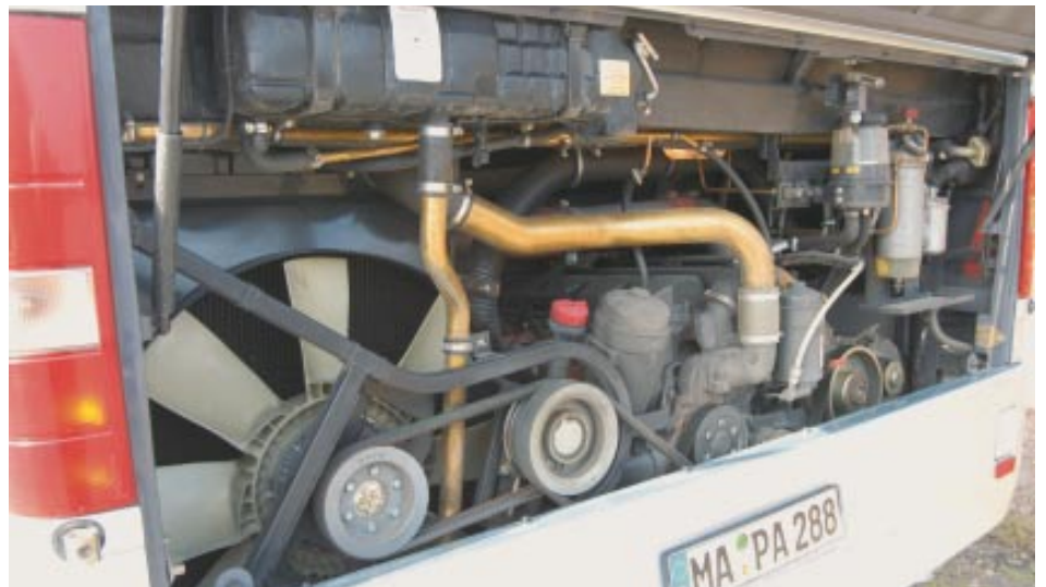
Mehr Power braucht keiner – mit 422 PS und 1.900 Nm Drehmomentmaximum zeigt sich der Reihen-sechszylinder von seiner besten Seite.
