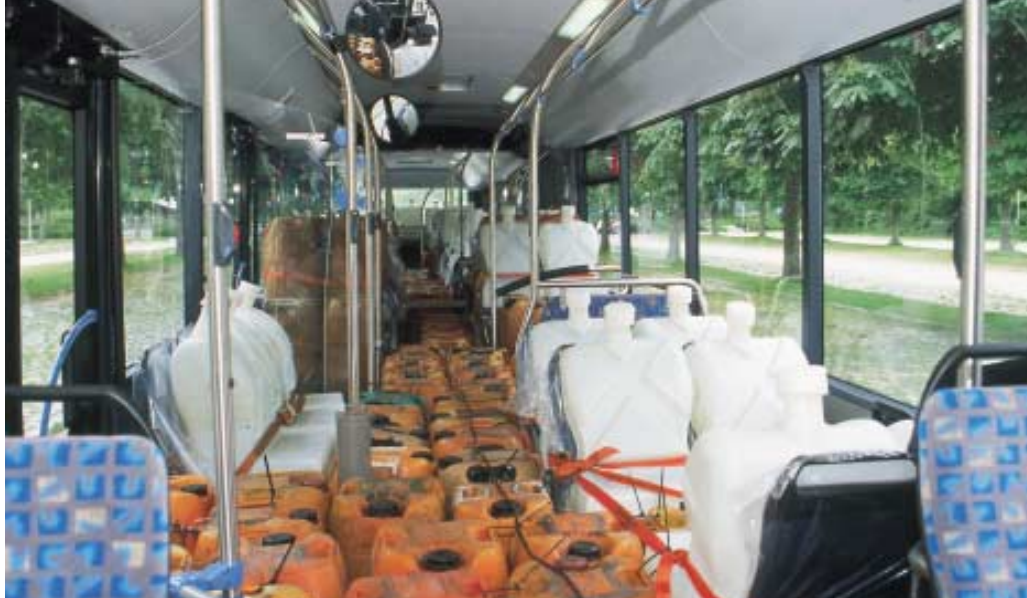
Im Test sind wir mit 9.100 kg Nutzlast unterwegs – was etwa 130 Fahrgästen oder 80 Prozent der Kapazität entspricht.
