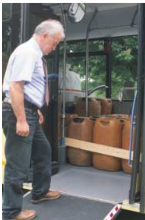
Ausklappbare Rampe für Rollstuhlfahrer an der dritten Tür: Mit Kneelingfunktion sind gerade 260 mm Einstiegshöhe zu überwinden.
