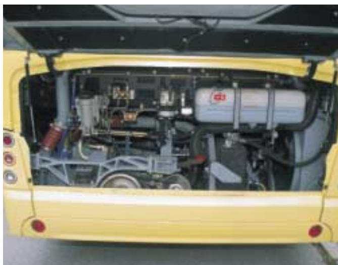
Links liegend im Heck der kräftige MAN-Reihensechszylinder mit 360 PS.
