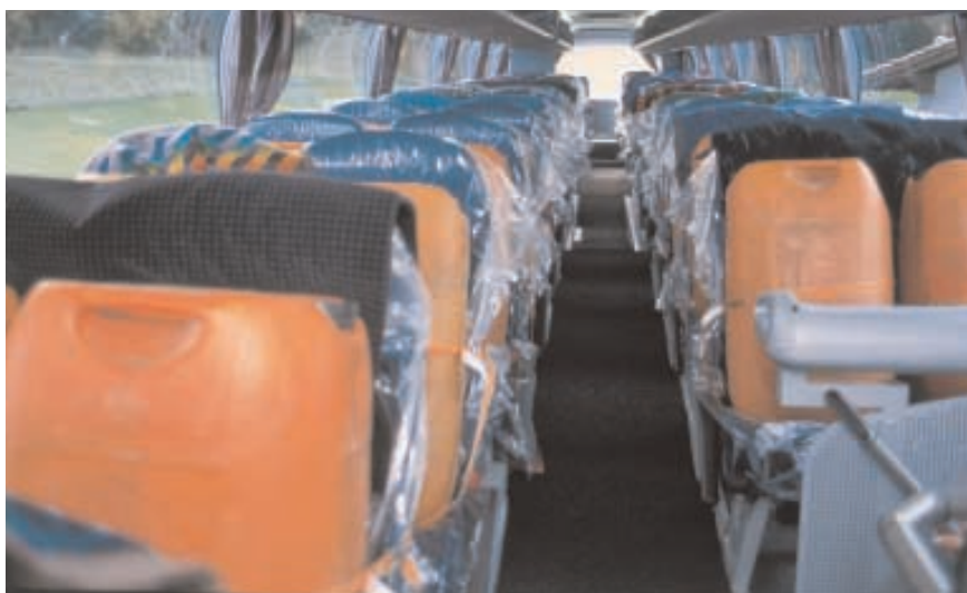
Im Obergeschoss eine Stehhöhe von 1.680 mm und eine gediegene Geräuschkulisse; auf den Fahrgast-Sitzen Ballast-Tonnen für einen realistischen Schwerpunkt
