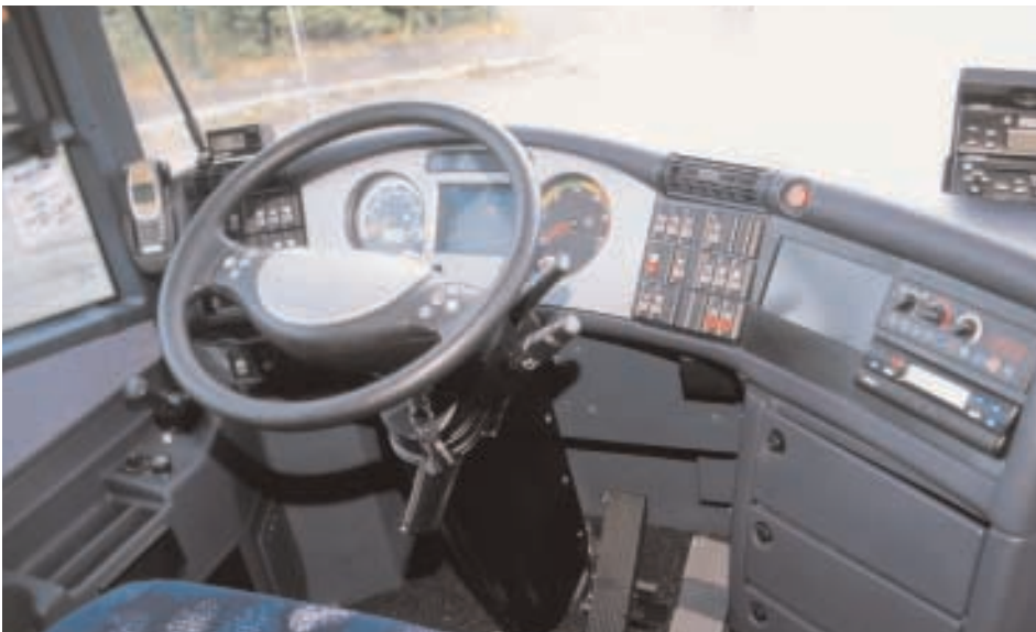
Ergonomie und Eleganz: Neues Cockpit mit zwei Rundinstrumenten und Zentralsdisplay
