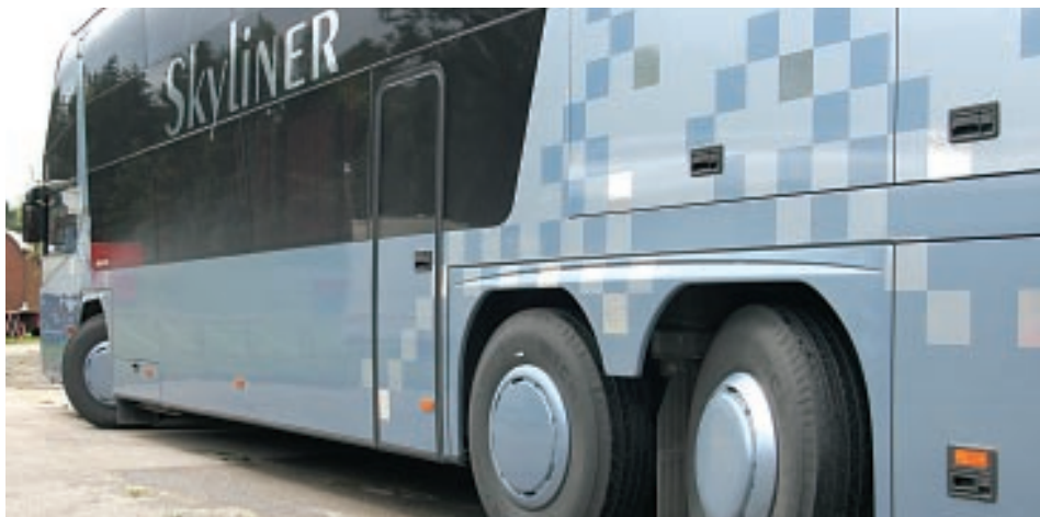
Wendig und präzise: Die Nachlaufachse lenkt vorwärts wie rückwärts aktiv mit.
